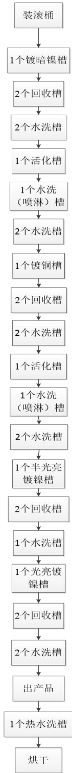
图 3.5-4 镀铜镍线工艺流程及产污环节图
